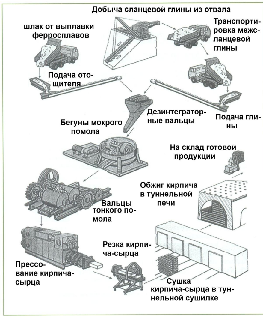
Рис. 4. Технология производства керамического кирпича
